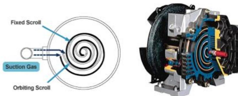
Figure 8 : l'architecture interne du compresseur d'Air à spirale.
