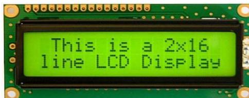
Figure 4 : Afficheurs LCD (16x2)
