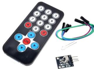
**Figure 7 : télécommande infrarouge avec récepteur**
