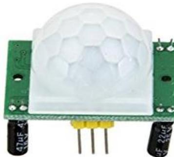
**Figure 15 : Capteur de mouvement (PIR)**
