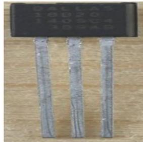
**Figure 11 : Capteur DS18B20 en boîtier TO-92**
