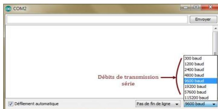
**Figure 27 : HyperTerminal de l'Arduino (Moniteur Série)**
