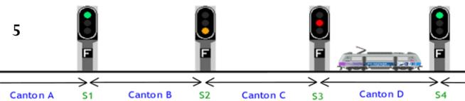
L'opération se répète lors de l'entrée dans le canton D avec la fermeture du S3, l'ouverture à l'avertissement du S2, le S1 quant à lui s'ouvre à voie libre.
