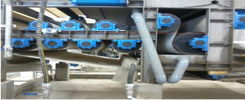
Figure 18 : Filtre à bande STEP Fès
