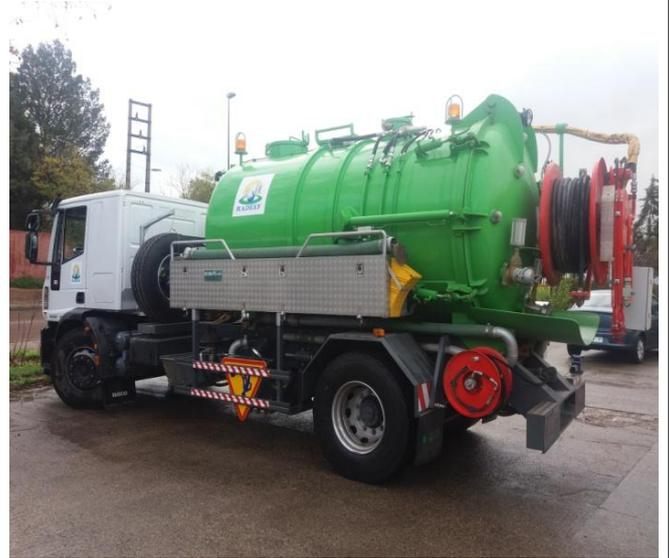
Figure 6 :Curage et débouchage par hydrocureuse
