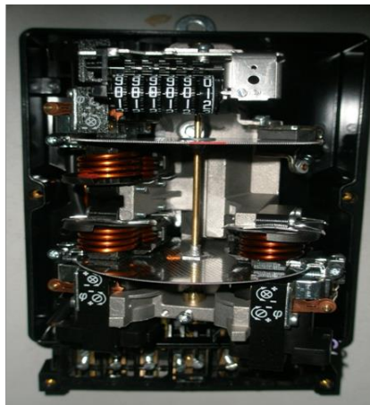
Figure2 : compteur triphasé C114
