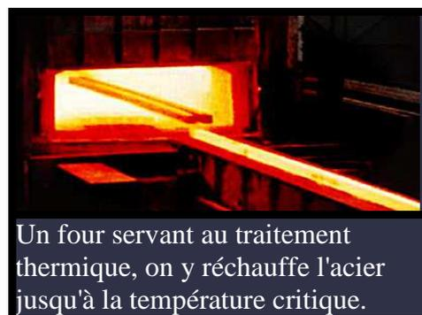
Un four servant au traitement thermique, on y réchauffe l'acier jusqu'à la température critique.
