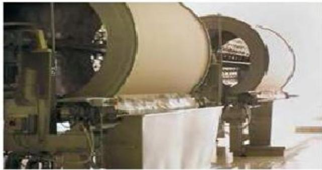
**Figure 12: filtre rotatif utilisé pour la filtration de la crème**
