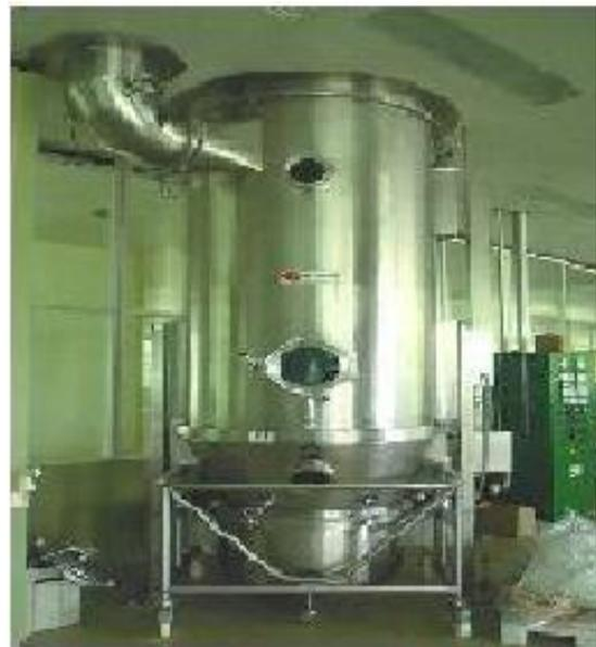
**Figure 7: sécheur de la levure**
