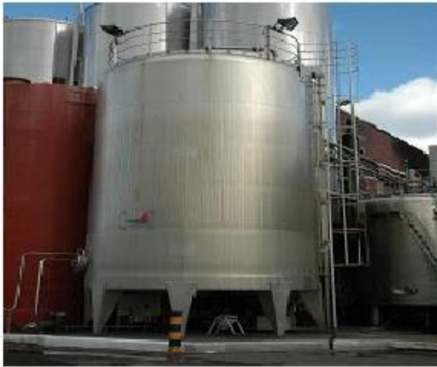
Figure 6 : Fermenteur utilisé dans la fabrication de la levure
