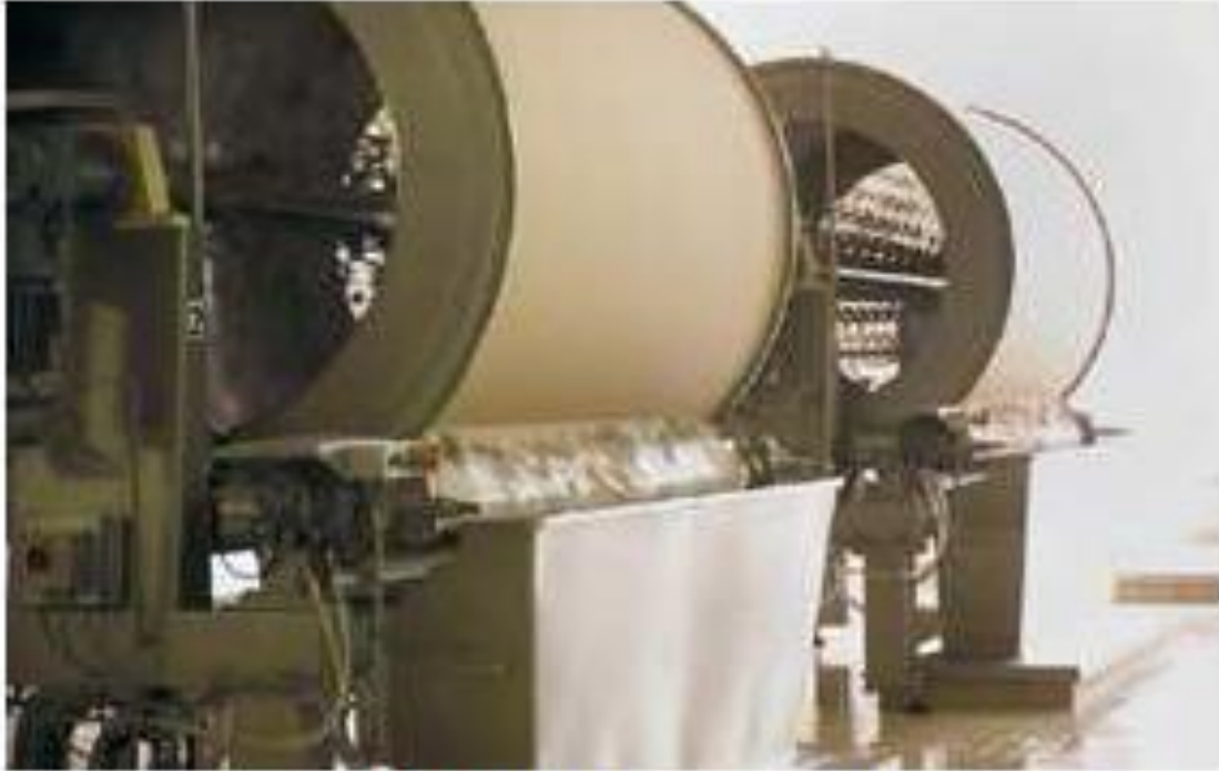
Figure 8 : Filtre rotatif utilisé pour la filtration de la crème
