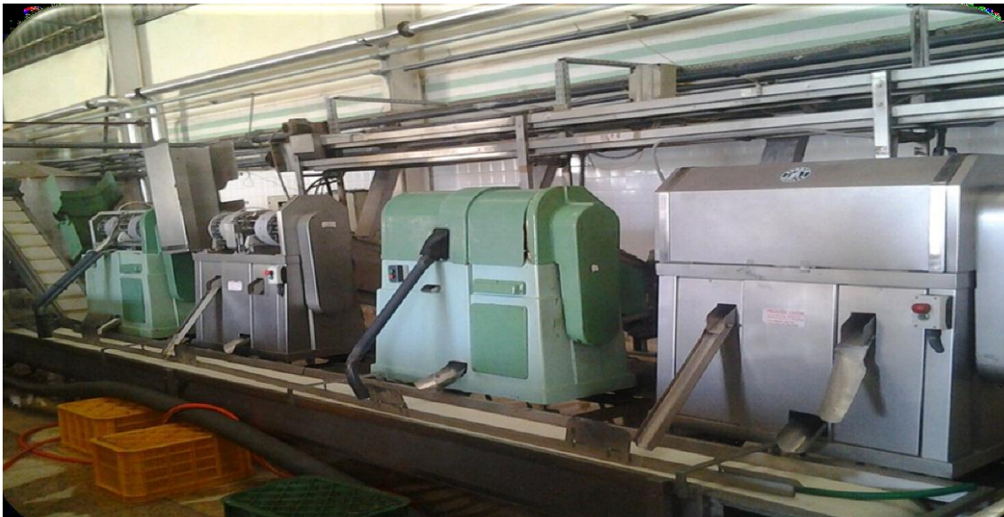
Figure 10 : ligne de dénoyautage
