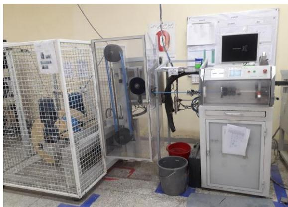
Figure 3: Coupe automatique "KOMAX KAPP"
