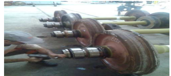
Figure 2.2 : photos de démontage des boites d'essieux
