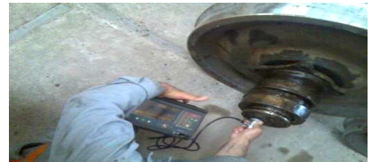
Figure 2.3 : photos du contrôle par ultra-son
