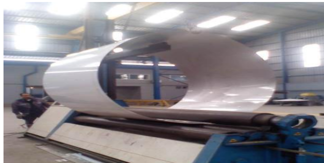
Figure3.3.1.2: la tôle aux niveaux de cintruse.
