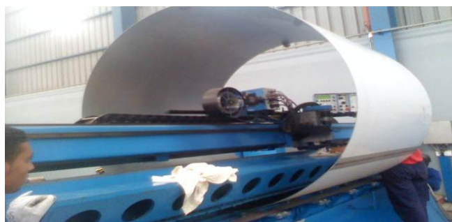
Figure3.3.1.3 : la virole aux niveaux soudage plasma.
