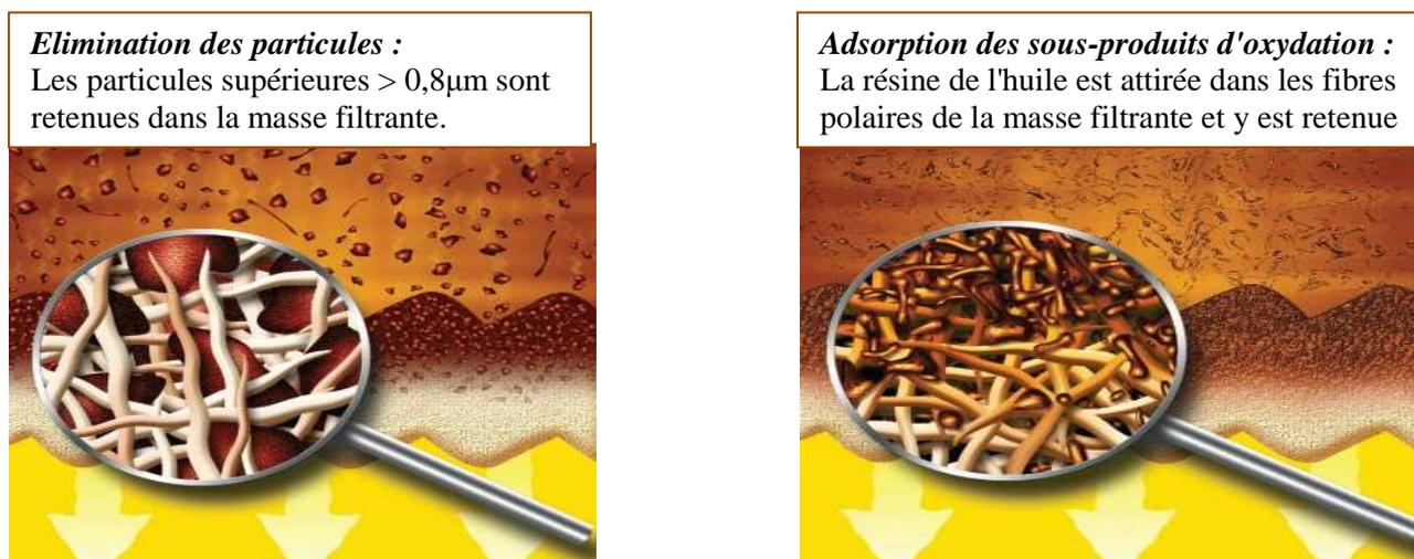
**Figure 5.4:** Principe de filtration des particules dans le filtre séparateur CJC™
