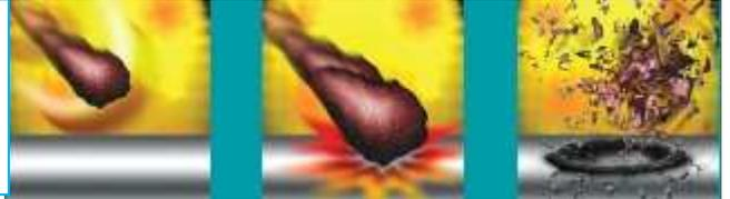
**Cavitation:** La cavitation se produit dans des zones où l'eau est présente et où l'huile est comprimée ; l'eau se condense, provoquant un craquelage des surfaces métalliques et la libération d'une plus grande quantité de particules.
