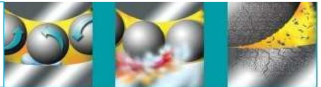
**Erosion:** Lorsque des particules solides sont piégées entre des pièces métalliques mobiles, la dégradation lente est provoquée par l'usure des surfaces. Les composants sont beaucoup plus souvent détruits par l'endommagement de leur surface que par la dislocation de leur volume.
