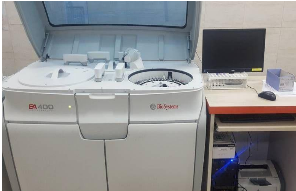
Figure 8 : Automate de biochimie (BA400)
