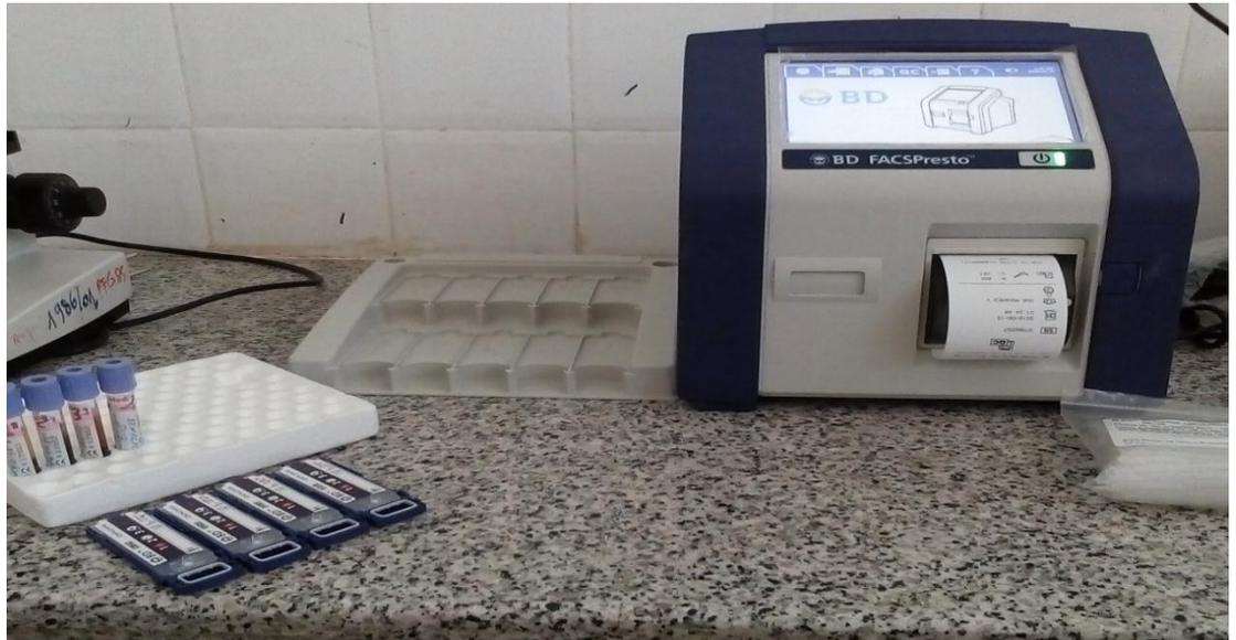
Figure 10 : Appareil utilisé pour le Comptage des CD4.
