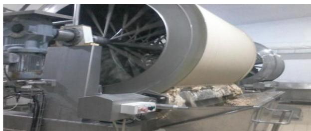
**Figure 3: Filtre rotatif**
