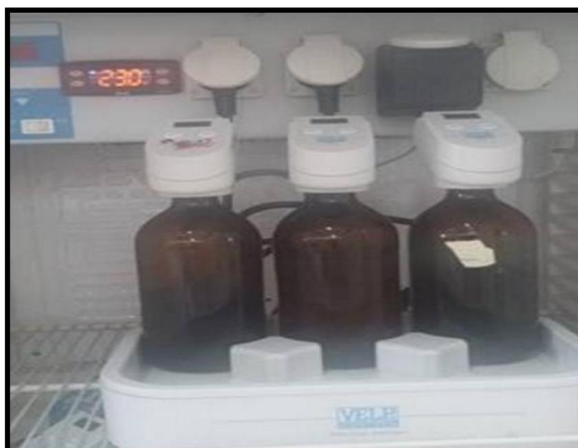
Figure 13 : Photo d'un DBO-mètre
