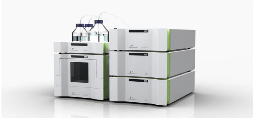
*Figure 13 : Appareil de la Chromatographie Liquide à Haute Performance*
