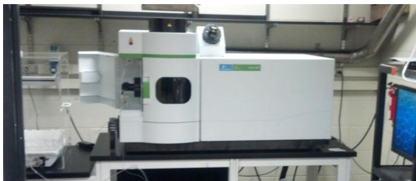
Figure 9 : Photographie d'un appareil ICP-AES Optima 8000 de la société PerkinElmer
