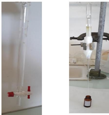
Figure 32: Petites colonnes utilisées pour purification.
