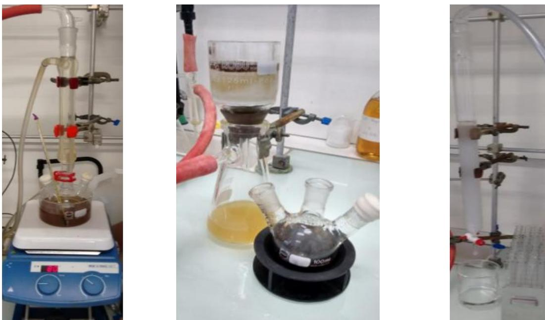
*Figure 30: Mise en place de la réaction de Wittig (à gauche) et étapes de purification (filtration sous vide au milieu et chromatographie sur colonne à droite).*
