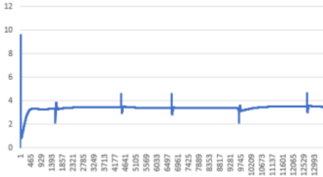
Figure 35 : vitesse de moteur D avec modèle LabVIEW
