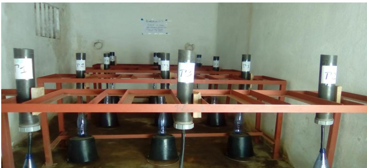
**Figure 16 : Dispositif expérimental adopté pour l'essai en colonne PVC**
