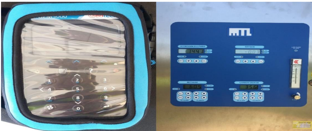
Figure 26: De gauche à droite, l'appareil GEM et l'analyseur de biogaz
