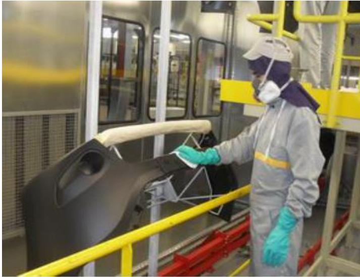
Figure I- 13 opération d'essuyage
