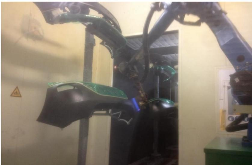
Figure I- 14 Robot de flammage .
