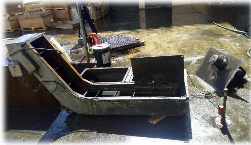
Figure 10 : Système de filtrage
