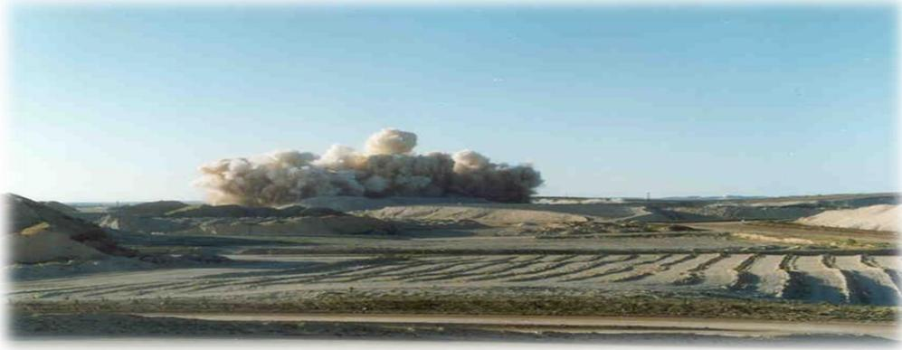
**Figure 6 : opération de sautage par des explosifs**
