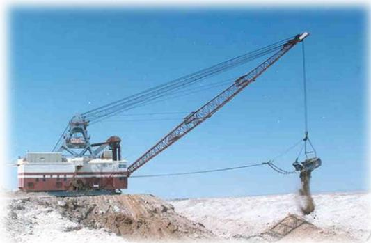
**Figure 7 : opération de décapage par dragline.**
