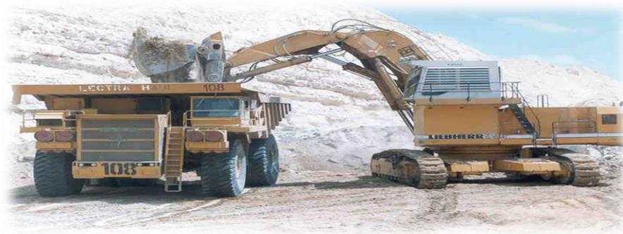
***Figure 9 : opération de défruitage par chargeuse.***
