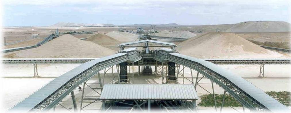
*Figure 11 : Convoyeurs et transporteurs des phosphates épierrés.*
