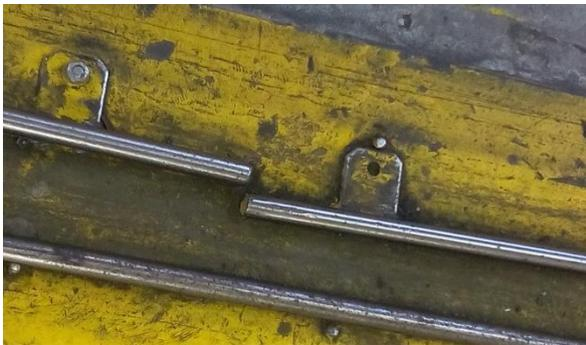
Figure39 : décalage des rails
