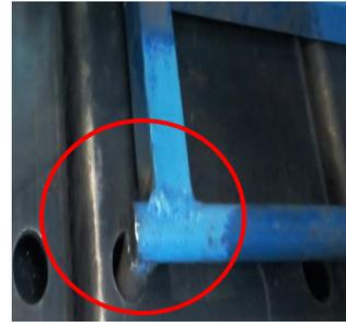
Figure20 : coïncidence des pieds avec les trous de convoyeur
