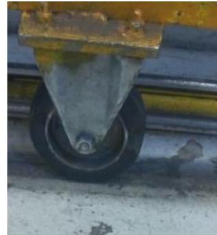
Figure40 : dégradation de la roue
