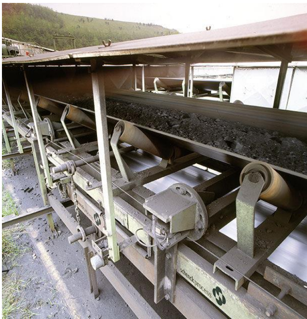
Figure 10:Convoyeurs et transporteurs des phosphates épierrés.
