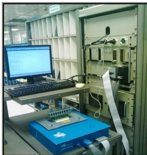
Figure 8 :Connexion de l'AutoJig au Test-Head et au Testeur
