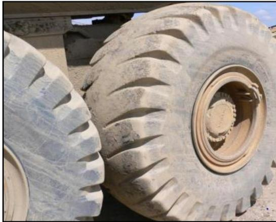
Figure 19 : Grande dimension des pneus des camions causant la compaction des sols.
