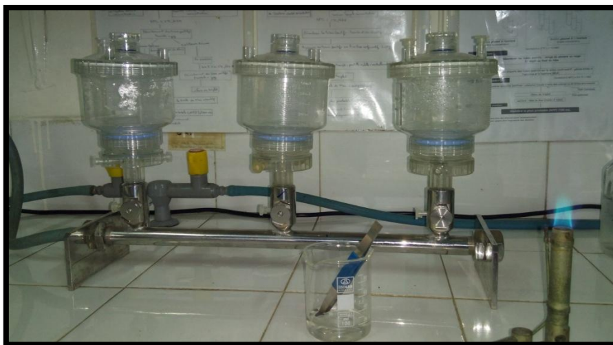
Figure IV. 5: Méthode de la membrane filtrante
