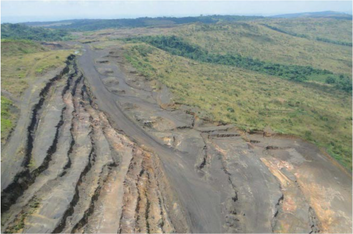
Figure 37: Technique d'exploitation en gradients
