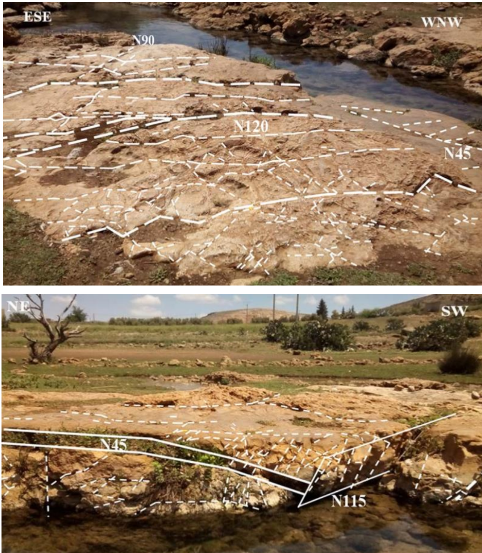
Figure 20 : représentation de la fracturation mesurée dans la station 5 à Ain Maârouf.
