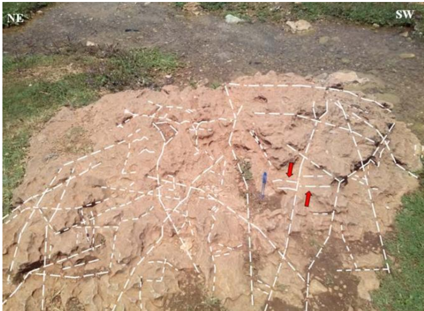
Figure 19 : représentation de la fracturation mesurée dans la station 4 à Ain Maârouf.
