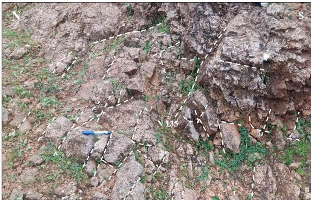
Figure 24 : représentation de la fracturation mesurée dans la station 1 à Ain Boujaoui.
