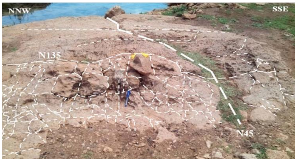
Figure 22 : Représentation de la fracturation mesurée dans la station 7 à Ain Maârouf.
