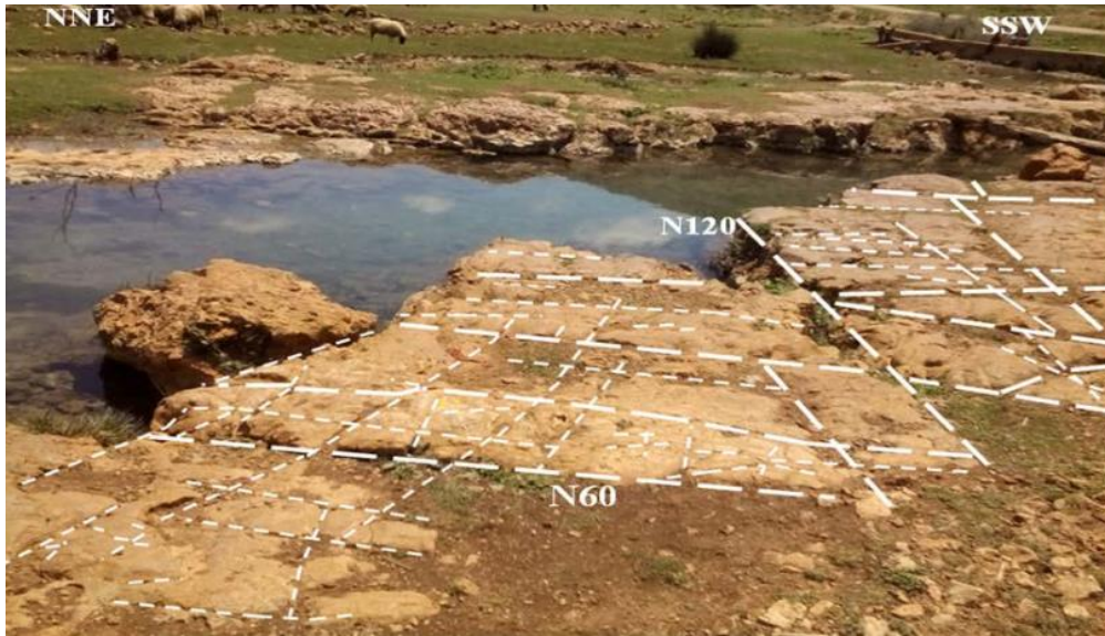
Figure 21 : Représentation de la fracturation mesurée dans la station 6 à Ain Maârouf.
