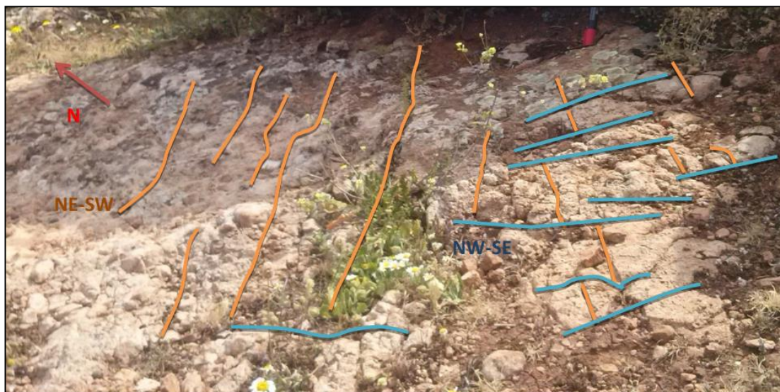
Figure 31 : Représentation des familles des fractures mesurées dans la station 1 à Ain Bouchermou
