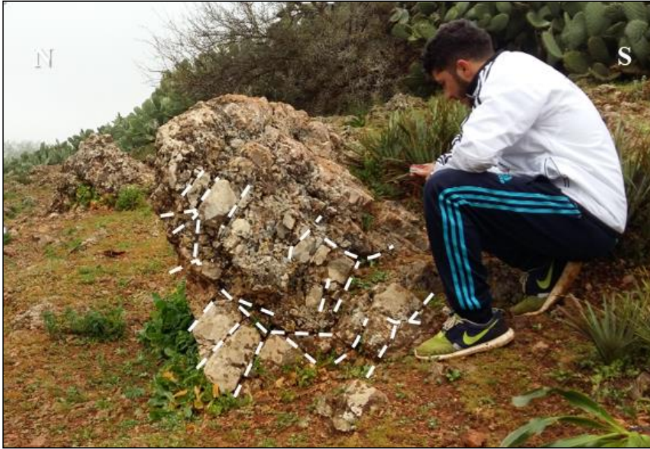
Figure 26 : Représentation des familles de fracture mesurée dans la station 3 à Ain Boujaoui.
