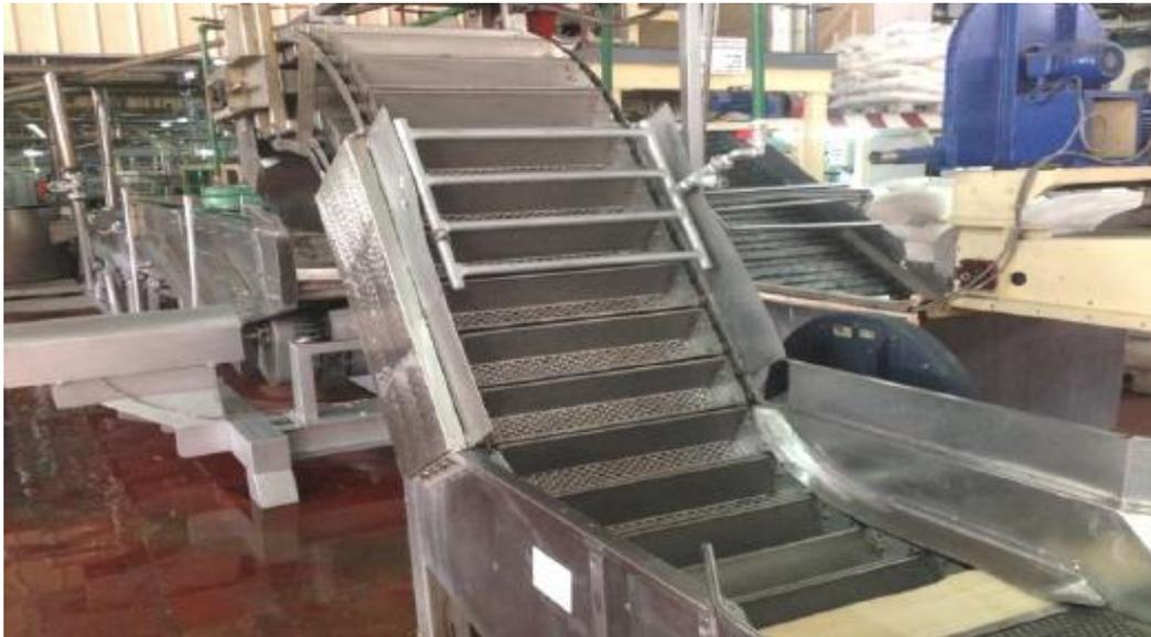
**Figure 3: élévateur de deuxième lavage (Essabti.A.2015) [3].**
