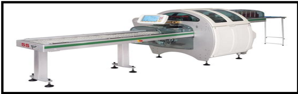
Figure 8 : Machine barquetteuse de découpes de dinde (filmeuse 55)
