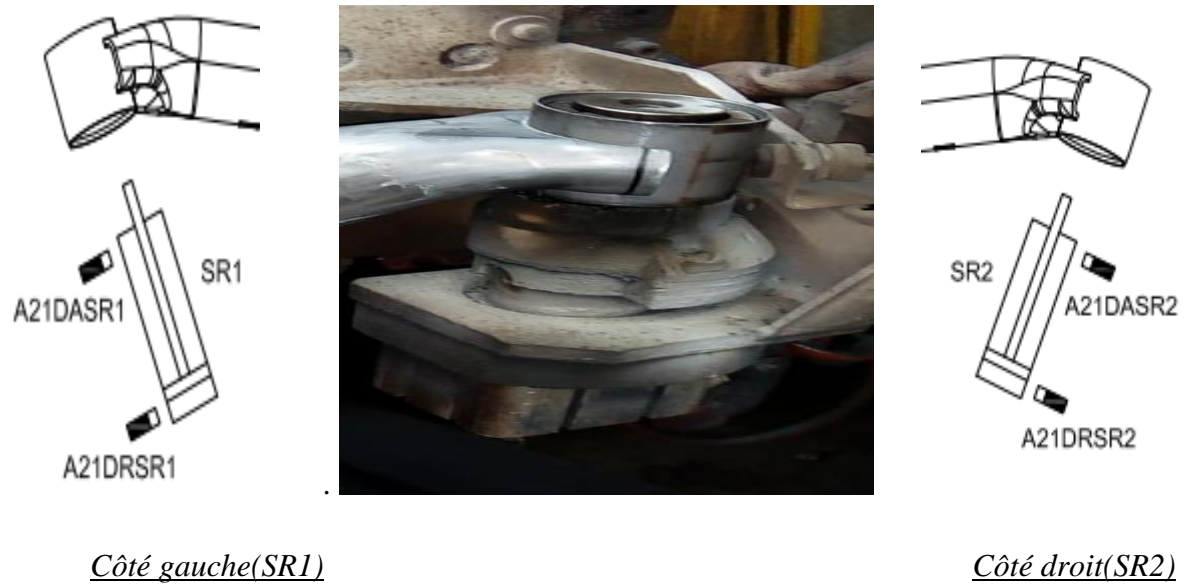
Figure 32 : vérin de serrage & desserrage de la douille
