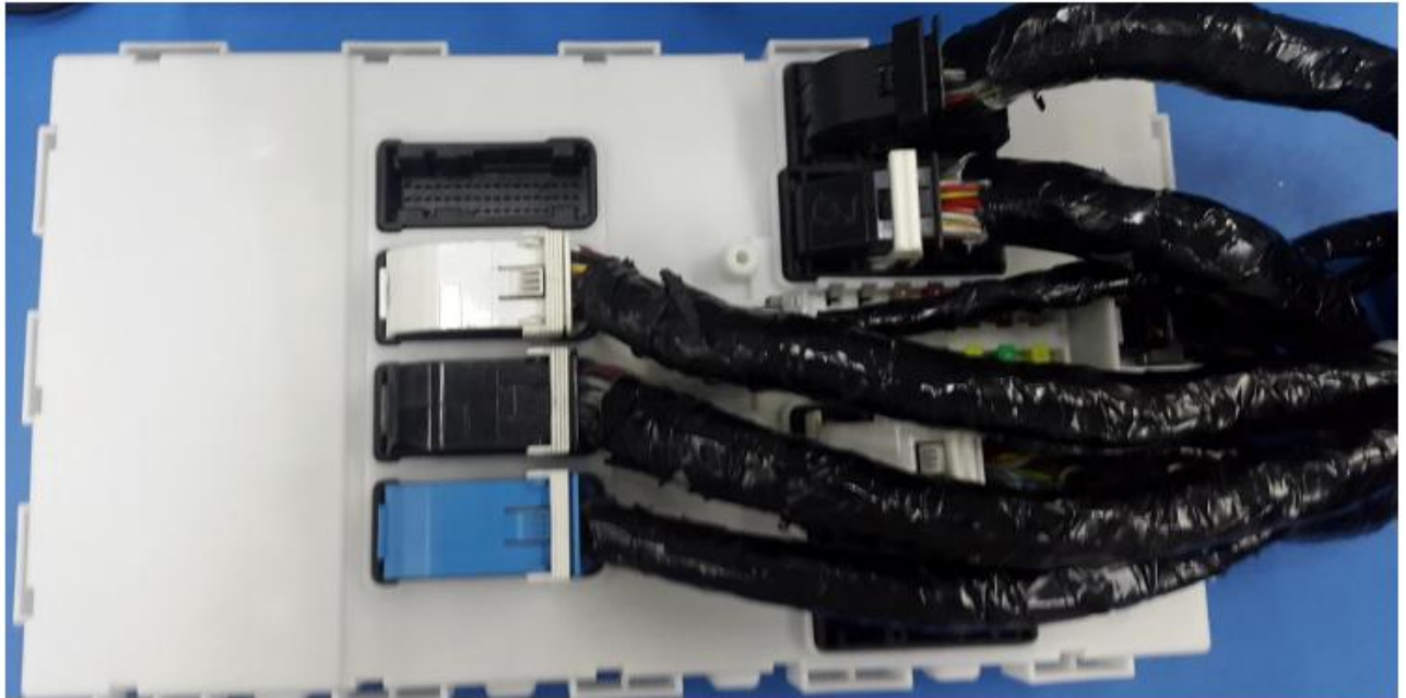
Figure 17: Connexion de la carte PL7
