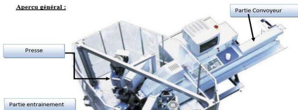
Figure 11: Le sous-système de la machine komax 355
