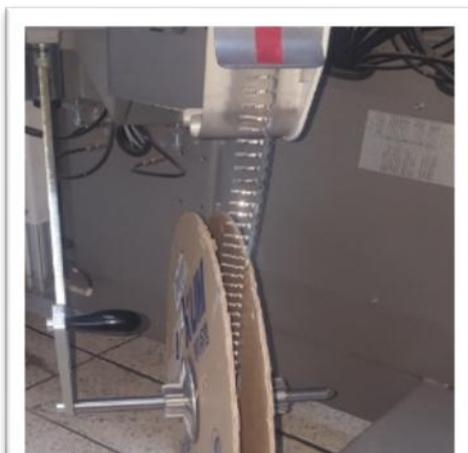
Figure 33: Support terminal avant l'application du SMED
