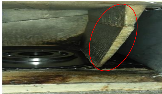
Figure 27 : la séparation par la tôle coudée
