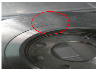
Figure 19: Tâches de colle présentes sur le disque
