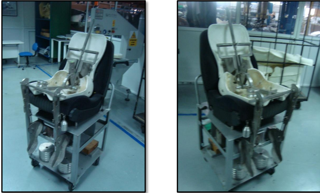
Figure 32: Mesures HCPP des IOD
