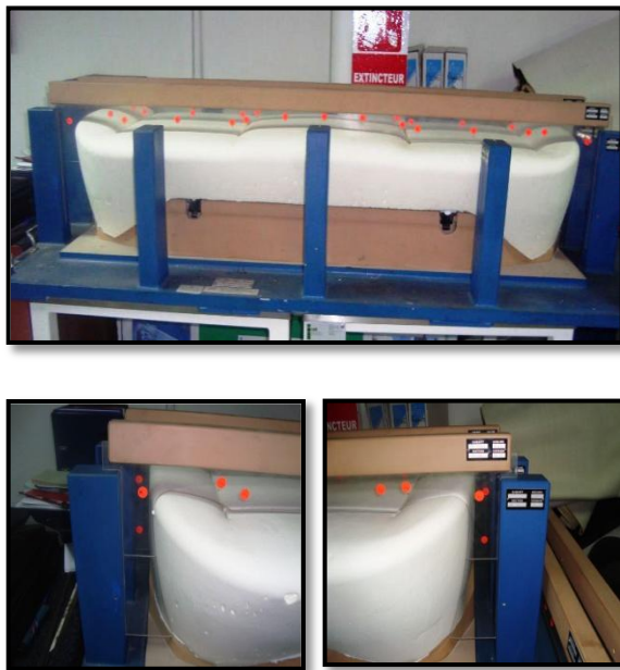
Figure 44: Gabarit de contrôle des mousses
