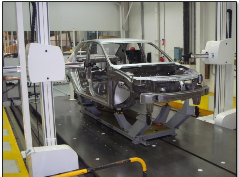
Figure 50: Laboratoire de mesures tridimensionnelles de la tôle
