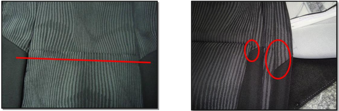
Figure 58: Mauvais assemblage et dissymétrie des coiffes DAV L90 E2
