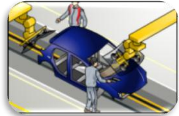
Pose du bard-brise
