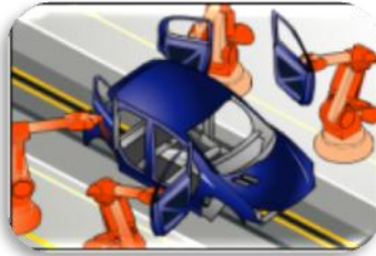
Démontage des portes
