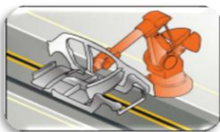
Assemblage des cotes de caisse
