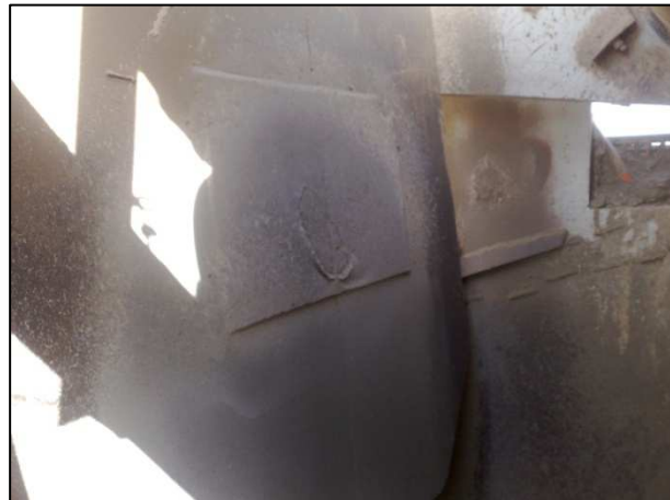
Figure 4 : Goulotte de jetée du convoyeur sortie concasseur. (Vue 2) Carrière HAZEMAG
