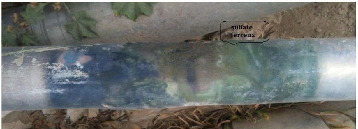
Figure 23 : influence de la corrosion sur l'arbre
