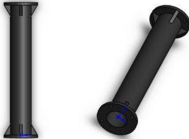
Figure 4 : enveloppe d'aspiration « partie inférieur »
