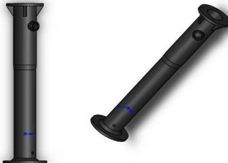
Figure 5 : enveloppe d'aspiration « partie supérieur »
