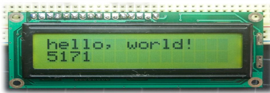
Figure 30 : Afficheur LCD 16x2, affichage noir sur fond vert
