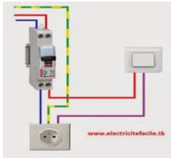
Figure 14 : Schéma pour une prise commander par un interrupteur
