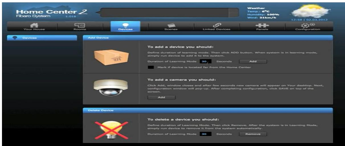
Figure 23 : Rubrique Devices dans l'interface du Home Center
