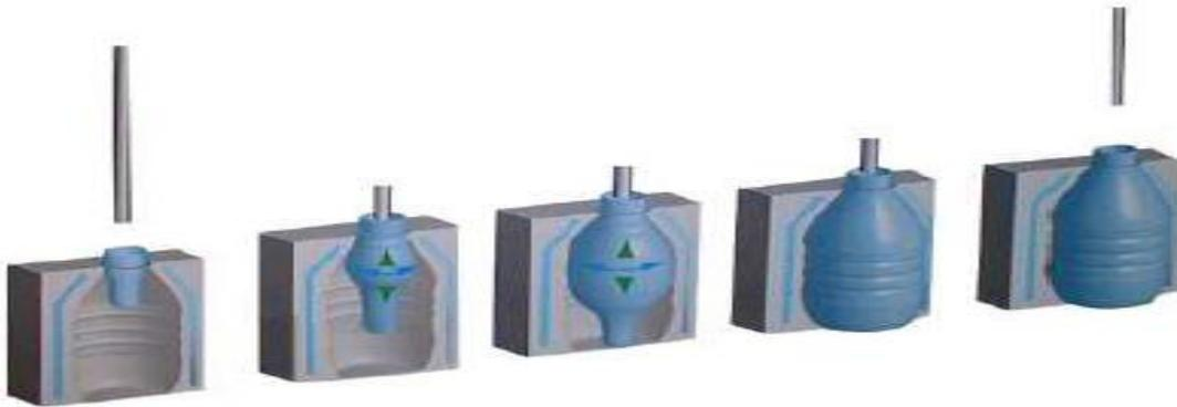
Figure 16 : Principe du soufflage
