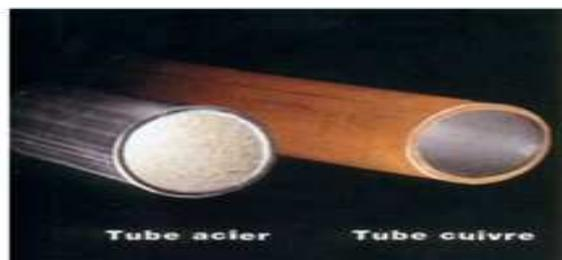
**Figure 29:** Entartrage comparatif entre le cuivre et l'acier pendant 30 jours et à 55°C
