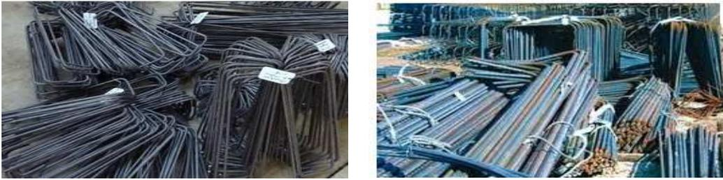
**Figure1** : Armatures Coupées Façonnées
