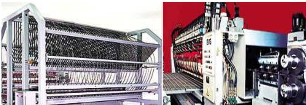
**Figure 8 :** ligne de soudage des nappes d'armature
