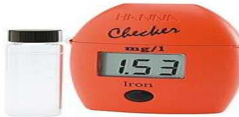
**Figure 32:** Photomètre de poche pour la mesure de teneur en Fer dans l'eau
