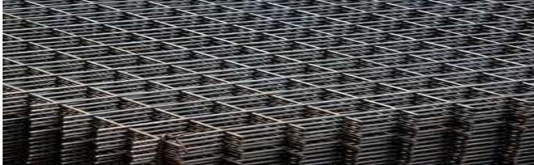
**Figure 5 :** Treillis soudés.
