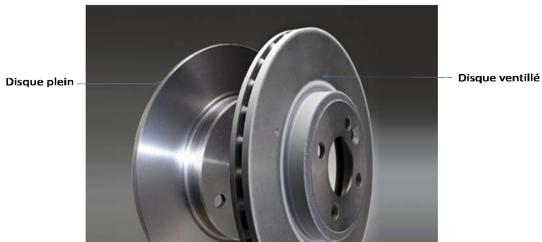
Figure N° 4 : les disques pleins et ventilés
