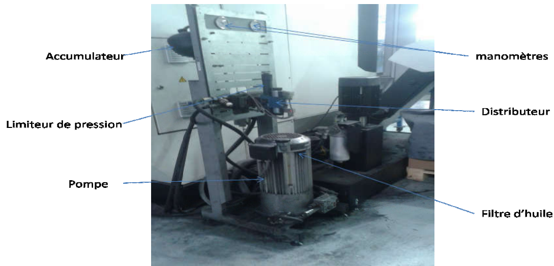
Figure N°8 : le groupe Hydraulique
