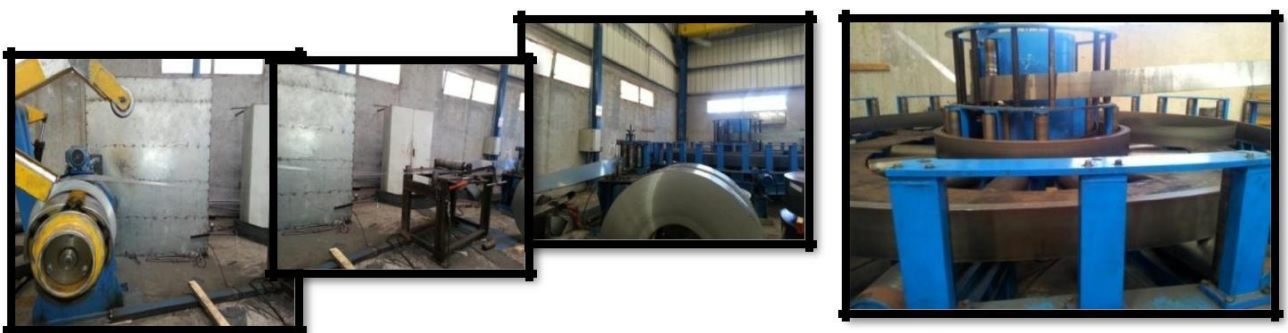
Figure 7 : Alimentation du réservoir de feuillard/ Réservoir de feuillard machine tube I /
