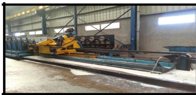
Figure 13: Dispositif de coupe longitudinale du tube Parvenant du bloc de calibrage.
