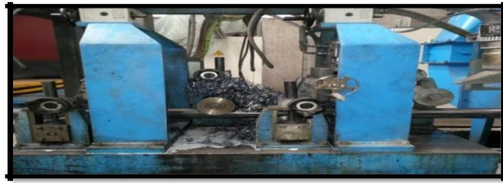
Figure 11: Raclage cordant extérieur de soudure
