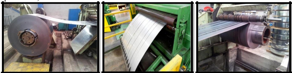
Figure 3 : Déroulement de la bobine à refendre /Refendage de la bobine par coupe /Enroulement des feuillards produits
