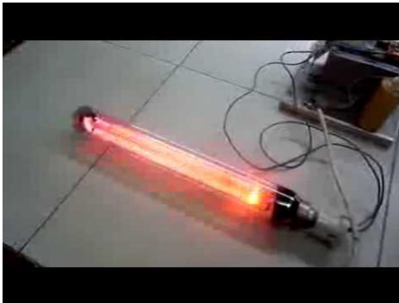
Figure 21 : lampe à Sodium à basse pression
